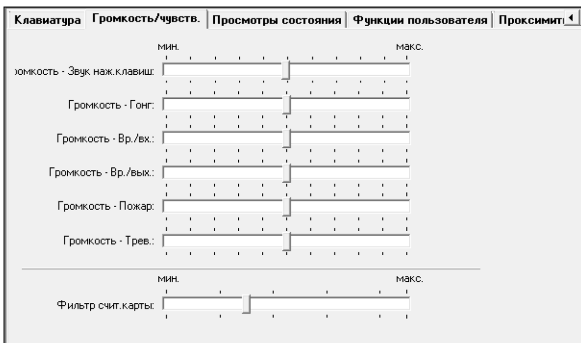
Рис. 6. Программа DLOADX: настройки клавиатуры, хранящиеся в приемно-контрольном приборе – закладка "Громкость/чувствительность".
