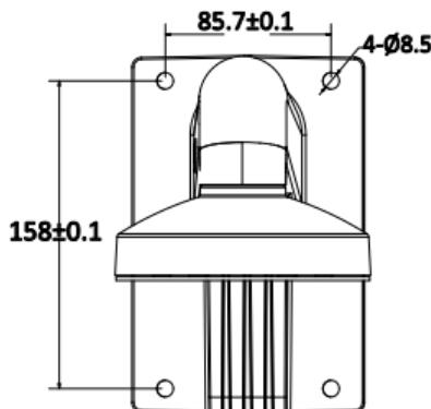
Рисунок 2-30 Размеры настенного кронштейна
