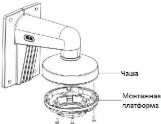
Рисунок 2-31 Установка монтажной платформы
