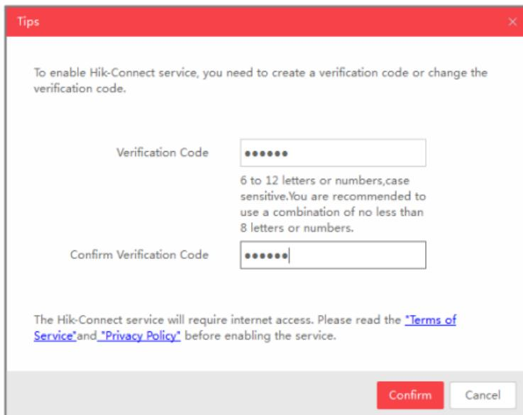
Рисунок 5-1 Настройка кода верификации (SADP)
