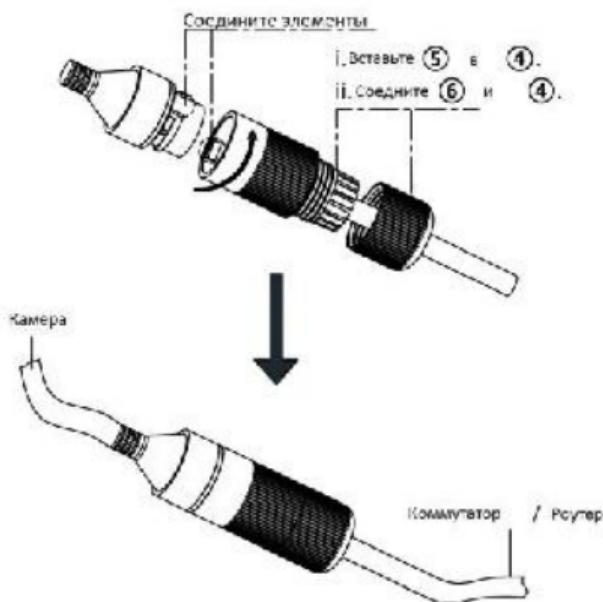
Рисунок 2-24 Установка компонентов гермоввода
