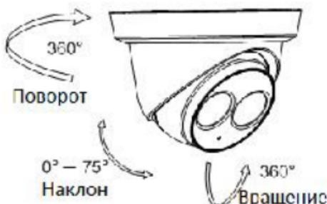
Рисунок 2-21 Настройка угла наблюдения
