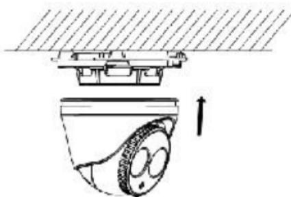
Рисунок 2-5 Установка камеры на монтажной платформе
