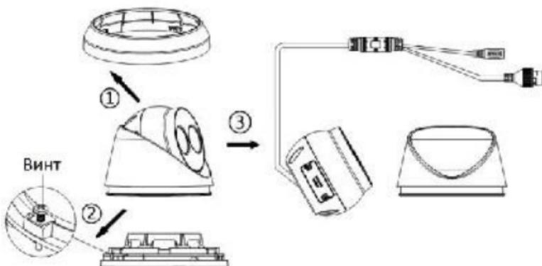
Рисунок 2-23 Демонтаж камеры
