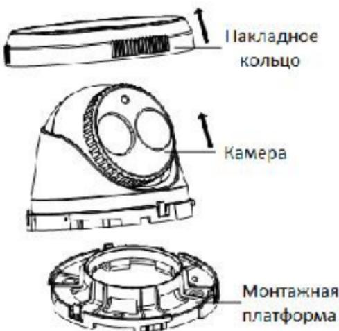
Рисунок 2-9 Демонтаж камеры
