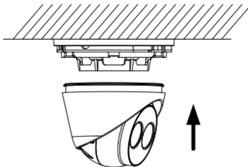
Рисунок 2-27 Установка камеры
