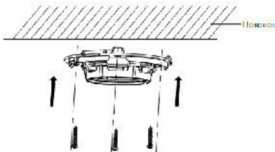
Рисунок 2-12 Крепление монтажной платформы на потолок
