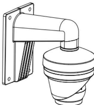
Рисунок 2-32 Настенная установка
