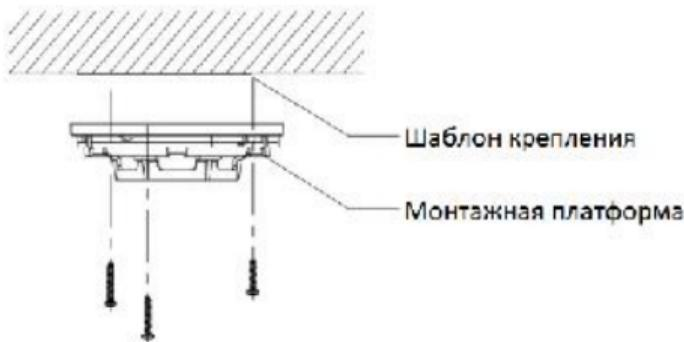
Рисунок 2-26 Установка монтажной платформы
