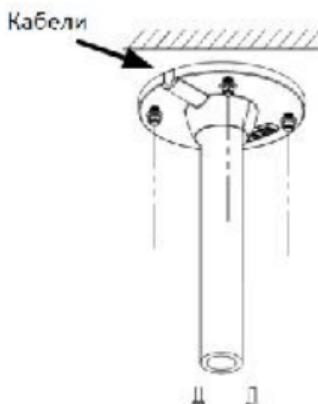
Рисунок 2-33 Установка подвесного кронштейна
