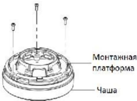
Рисунок 2-34 Установка монтажной платформы
