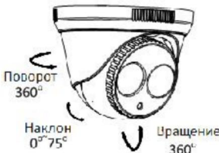
Рисунок 2-13 Настройка угла наблюдения
