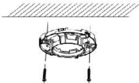
Рисунок 2-19 Крепление монтажной платформы на потолок
