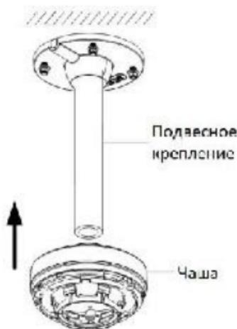
Рисунок 2-35 Установка чаши на подвесное крепление
