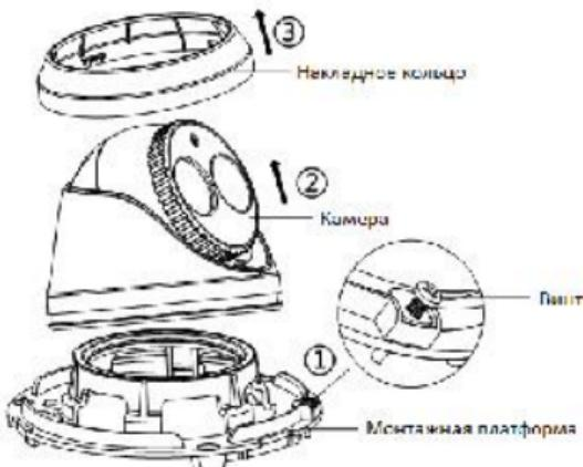
Рисунок 2-1 Демонтаж камеры
