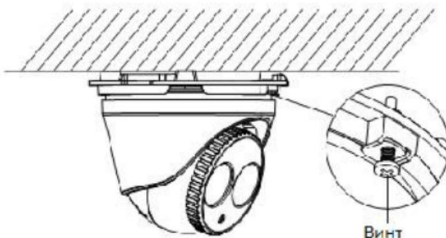
Рисунок 2-6 Фиксирующий винт
