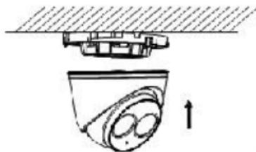
Рисунок 2-20 Установка камеры
