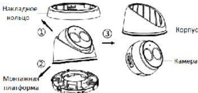
Рисунок 2-15 Демонтаж камеры
