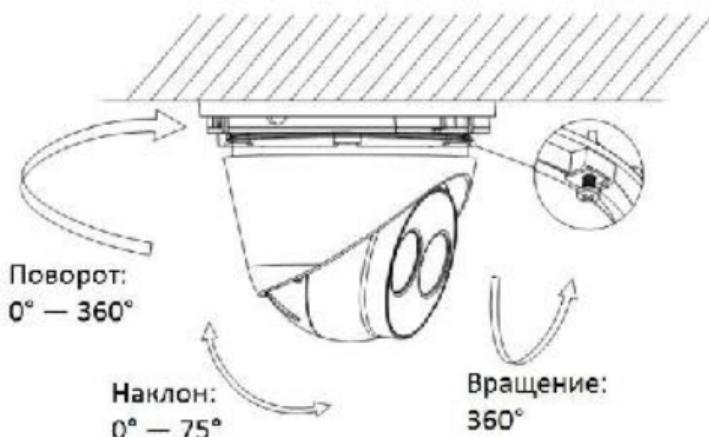
Рисунок 2-28 Настройка угла наблюдения
