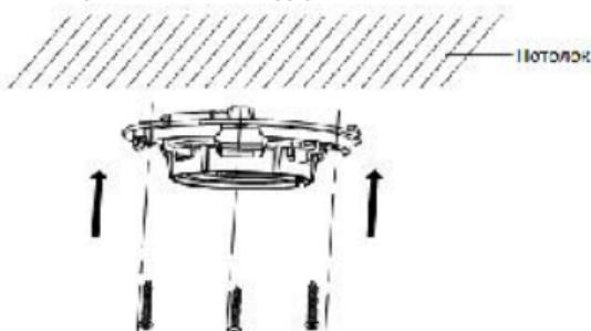
Рисунок 2-4 Крепление монтажной платформы на потолок
