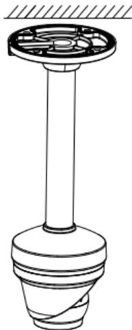
Рисунок 2-35 Потолочная установка
