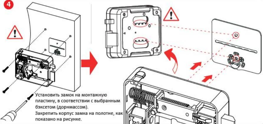
Установить замок на монтажную пластину, в соответствии с выбранным бэксетом (дорнмассом).
