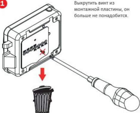
Выкрутить винт из монтажной пластины, он больше не понадобится.
