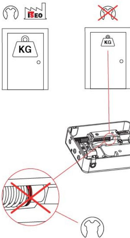
Для снижения усилия требуемого для закрывания двери, можно снять стопорное кольцо.
