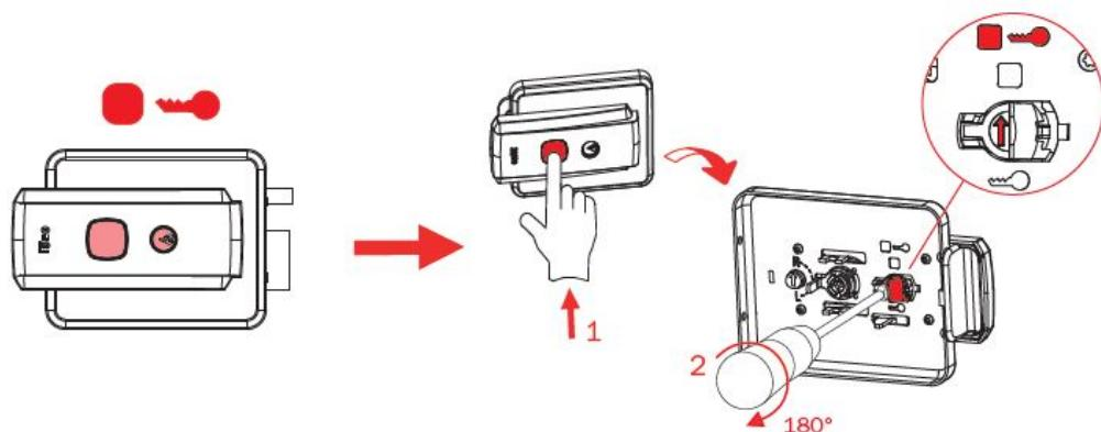
При использовании заглушки для цилиндра, замок остается в режиме открывания только кнопка.
