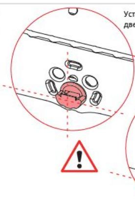
Установить цилиндр и монтажную пластину на полотно двери (калитки) стянув винтами, как показано на рисунке.
