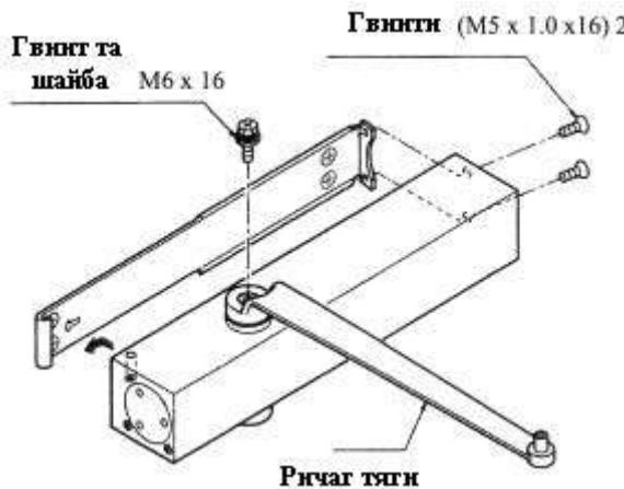
**2. Встановити тягу на верхню раму і монтажну пластину на двері.**
