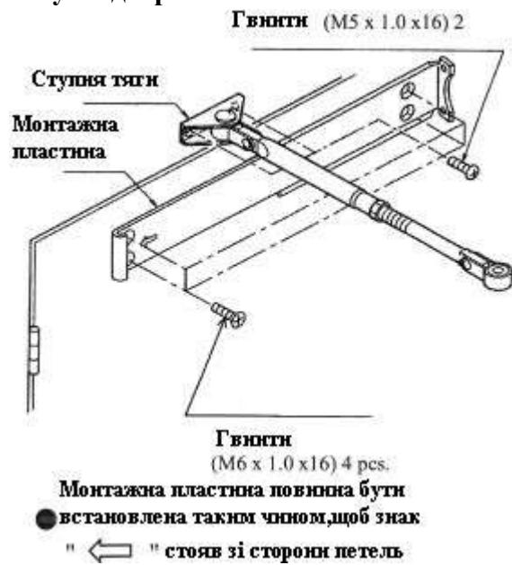
**4. З'єднати тягу з ричагом тяги, та закріпити гвинтом з шайбою M5x12, і надіти декоративну кришку на шток.**
