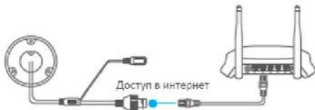
Рисунок 5-3 Подключение к роутеру
