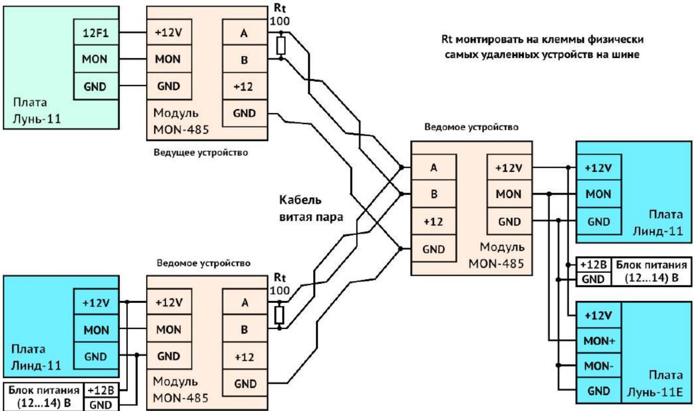
Рисунок 3. Пример подключения нескольких ведомых устройств с помощью модулей MON-485
