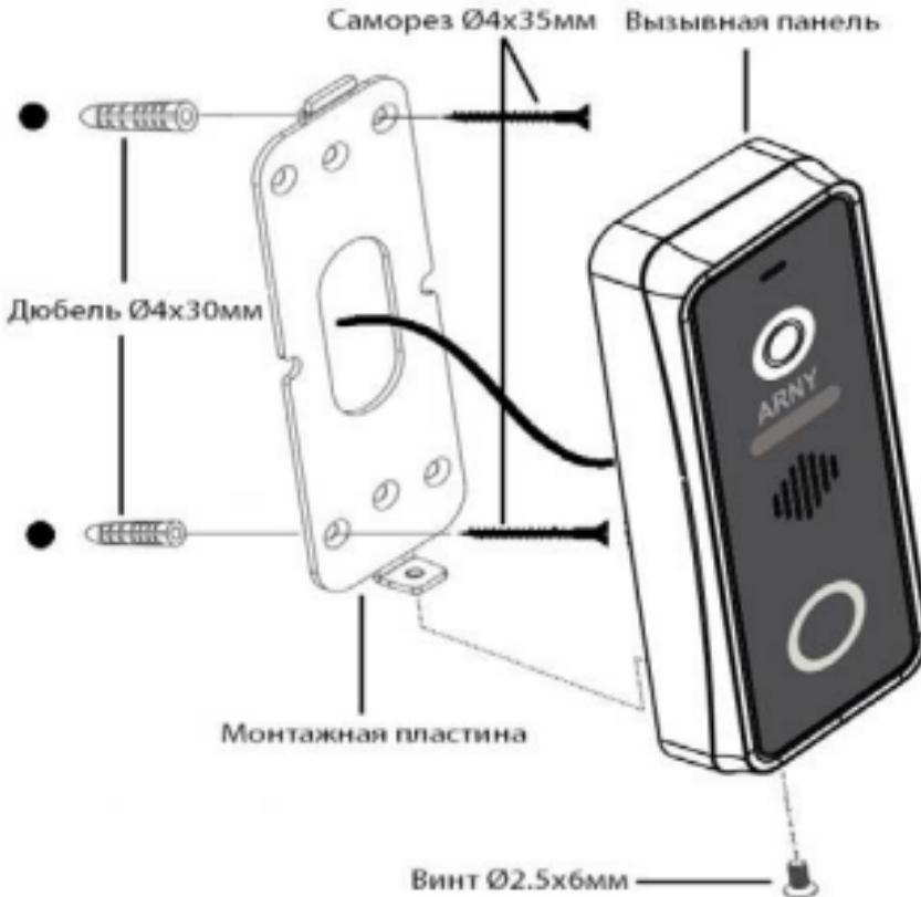
Схема установки панели с использованием монтажного уголка (в комплект не входит):
