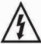
Данное устройство при определенных условиях может иметь опасно высокое напряжение внутри корпуса, которое может вызывать поражение электрическим током.
