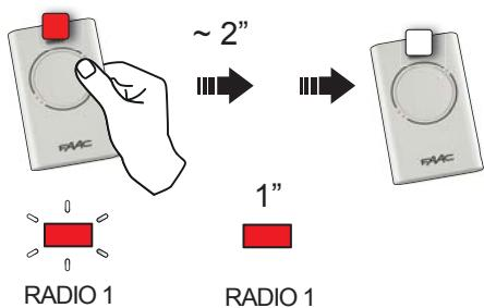
**Нажать и удерживать кнопку пульта, выбранную для управления створкой (например P1) - диод пульта должен гореть постоянно. По истечению не более 2x секунд индикатор RADIO1 загорится постоянным светом на 1 секунду. Отпустить кнопку P1.**
