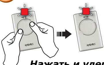
**Одновременно нажать кнопки P1 и P2 на пульте "мастер" и отпустить кнопки когда индикатор замигает (через 1-2 секунды). В течение последующих 10 секунд выполнить действия:**
