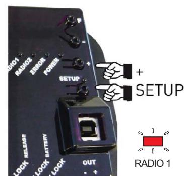
**Подать с пульта 3-4 импульса длительностью до ~3 секунд каждый. Управление воротами будет выполняться, согласно логического алгоритма "E". Для изменения алгоритма и режимов работы и для записи дополнительных пультов - обратиться к полным инструкциям на плату E721 и пульты.**
