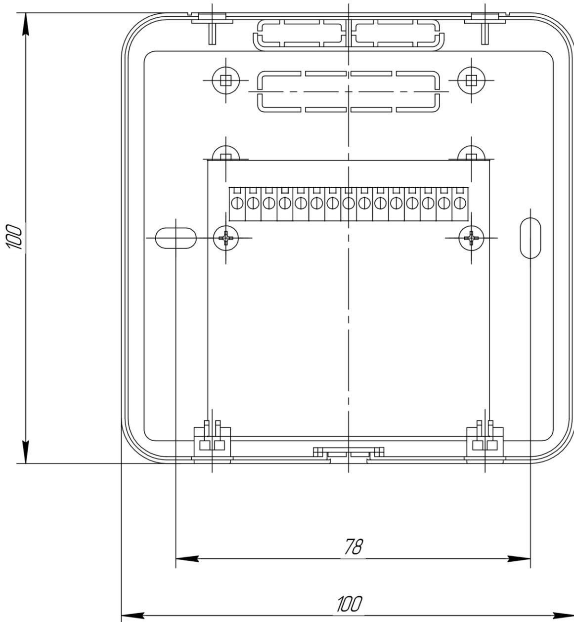
Рисунок 1 - Установочные размеры модуля M-Z box
