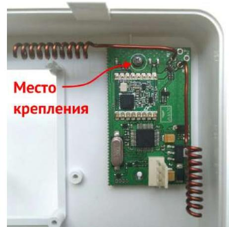
Рисунок 16. Радиоприемник Ajax «uartBridge» в корпусе ППКОП
