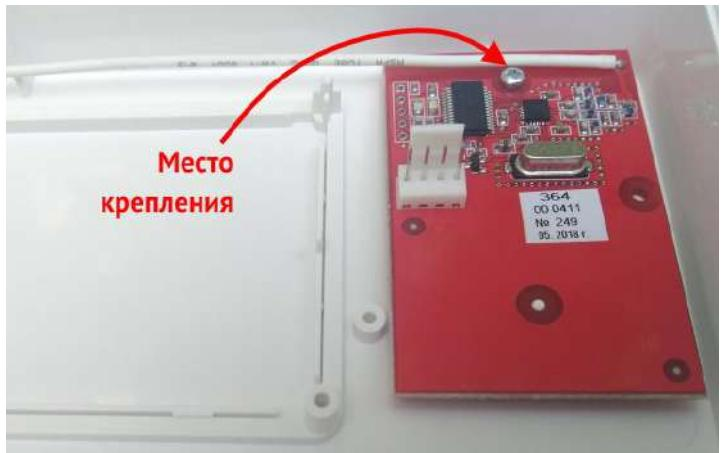
Рисунок 14. Радиоприемник «Lun RKI v3» в корпусе ППКОП
