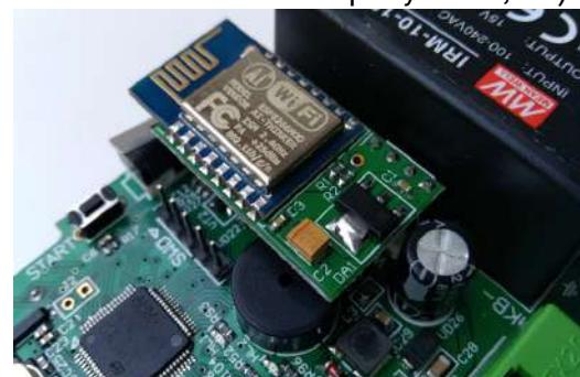
Рисунок 18. Установка WiFi модуля
