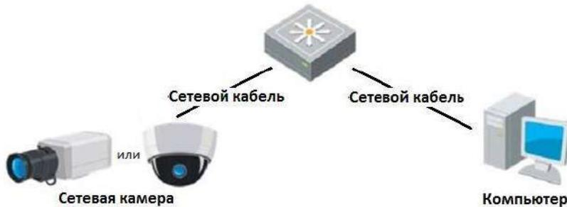
Рисунок 2-2 Подключение через коммутатор или роутер
