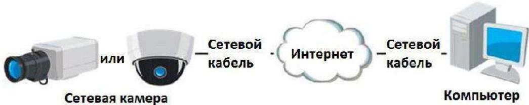
Рисунок 2-11 Доступ напрямую к видеокамере со статическим IP-адресом
