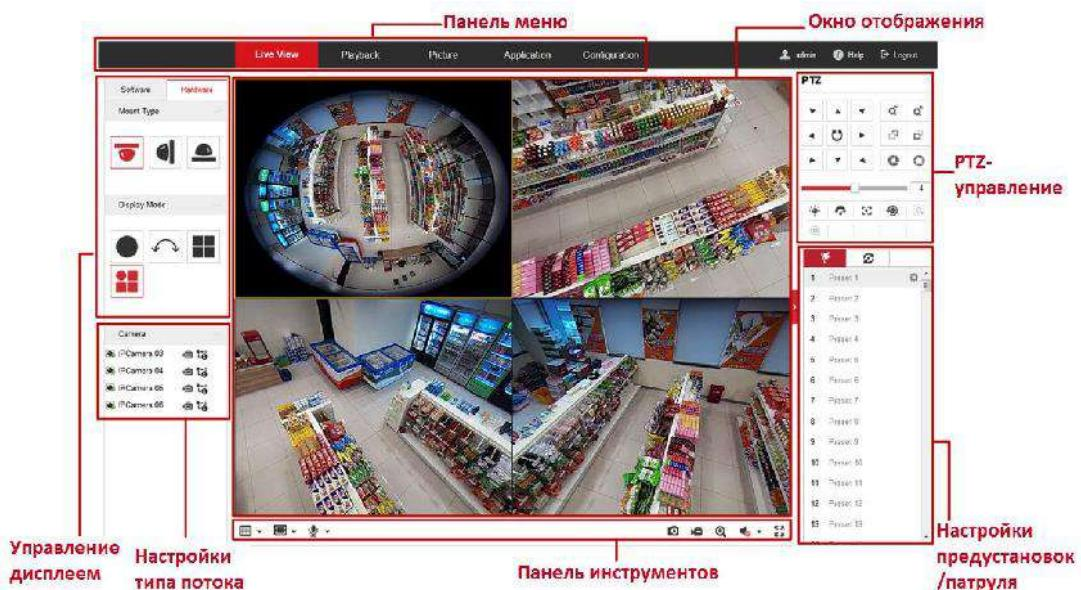
Рисунок 4-2 Интерфейс отображения (Аппаратное декодирование)
