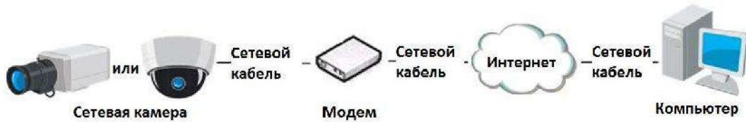
Рисунок 2-12 Доступ к видеокамере с динамическим IP-адресом
