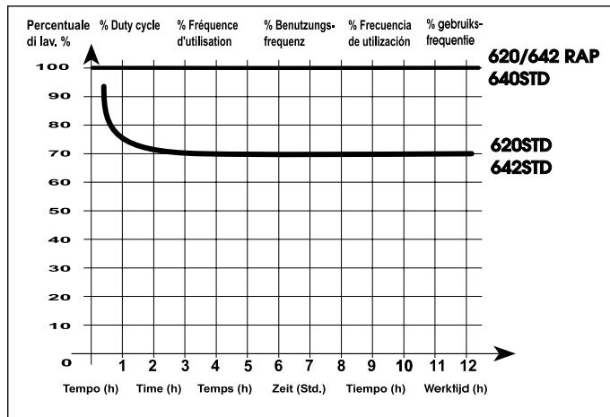
Для стабильной работы привода работайте в рабочем диапазоне по графику.
