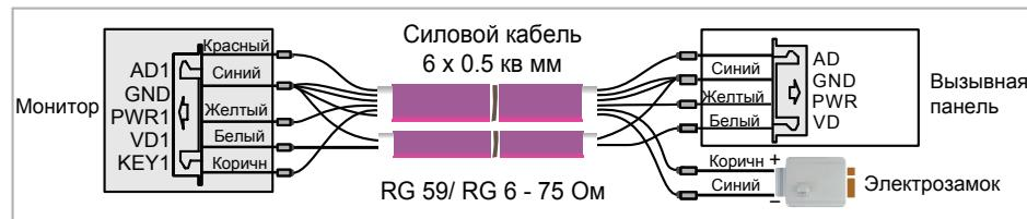
Для підключення декількох моніторів в інтеркомом (до 30 м) для відеосигналу використовуйте кабель RG59 / RG6-75 Ом, для живлення, GND і аудіо - кабель 2 x 0,5 кв.мм
