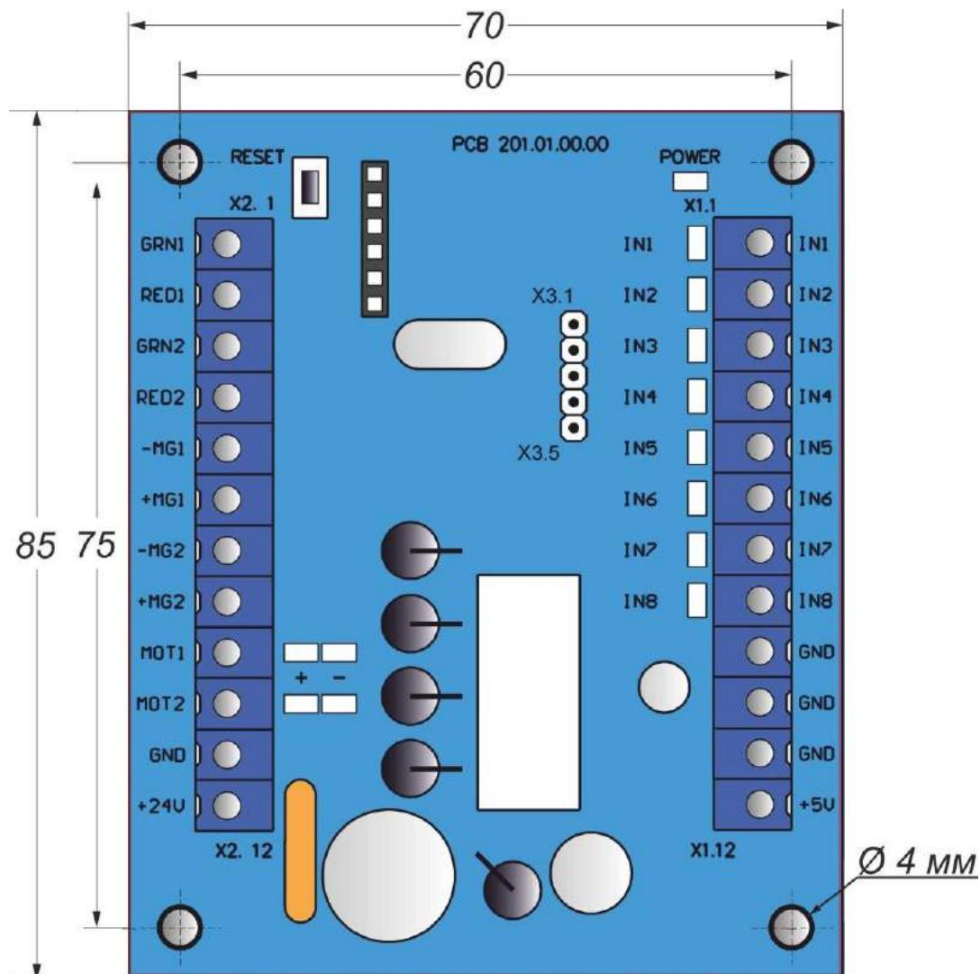
Рис. 9— Внешний вид контроллера моторизированного механизма PCB.201.01.00.00
