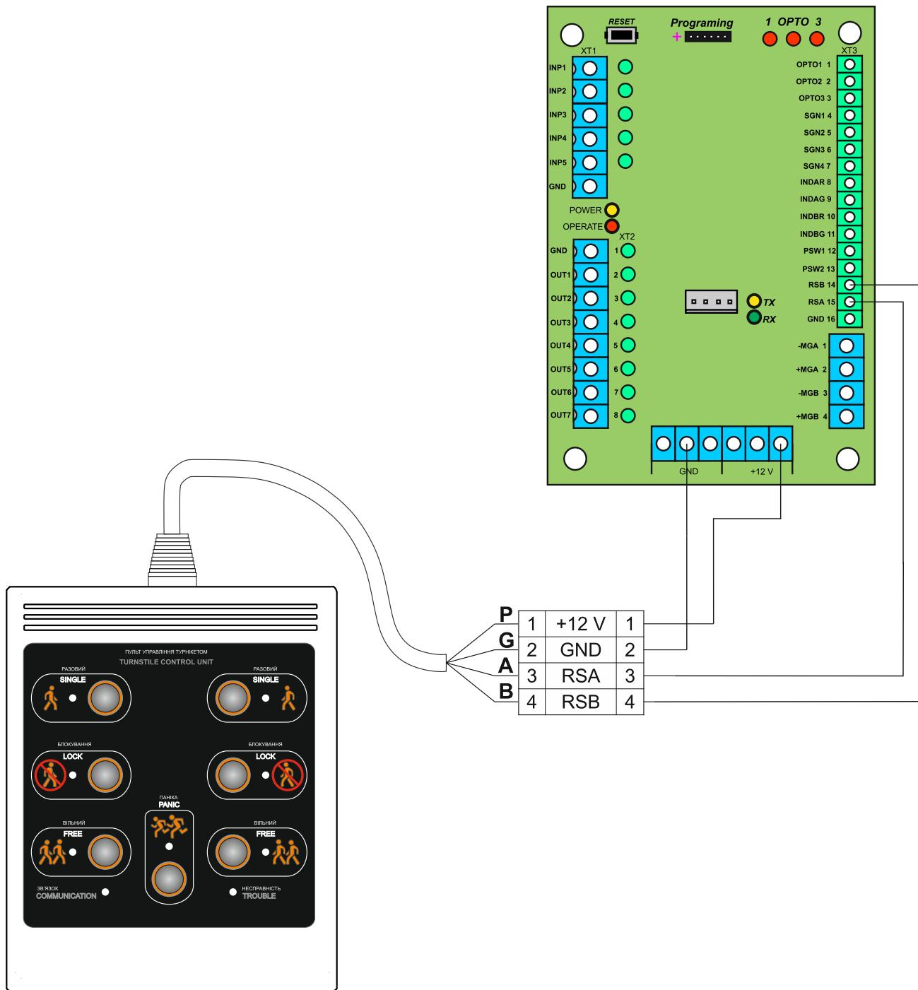
Рисунок Г.5 – Схема электрическая подключения турникета к пульту управления
