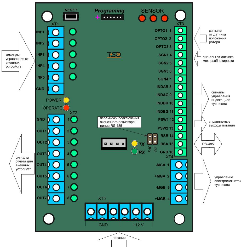
Рис. 10— Внешний вид контроллера турникета PCB.112.21.20.00
