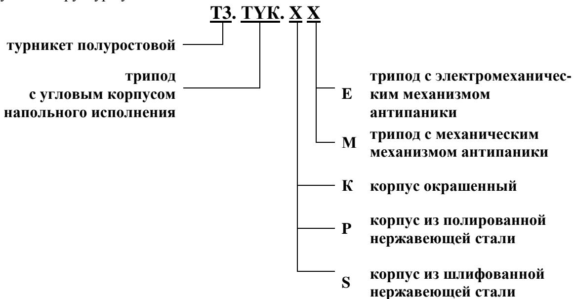
Пример записи обозначения турникета полуростового типа «трипод» с угловым корпусом из шлифованной нержавеющей стали с электромеханическим механизмом антипаники со стеклянной задней панелью при заказе:
