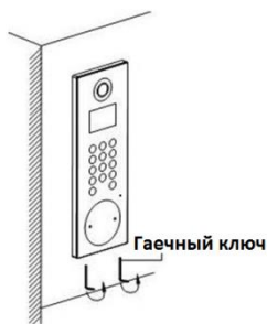
Рисунок 5-5 Затягивание винтов вызывной панели
