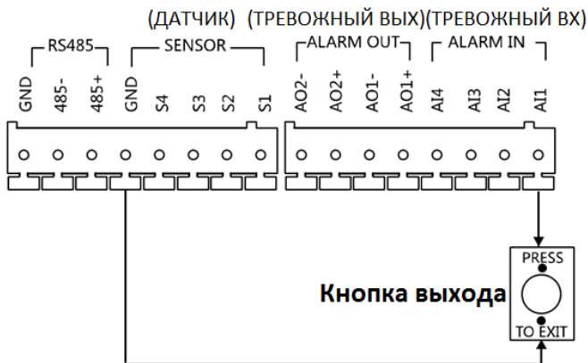
Рисунок 5-20 Подключение кнопки выхода для моделей DS-KD8102-V/DS-KD8002-VM (1)
