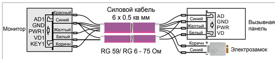
Для підключення декількох моніторів в інтеркомі (до 30 м) для відеосигналу використовуйте кабель RG59 / RG6-75 Ом; для живлення, GND і аудіо - кабель 2 x 0,5 кв.мм
