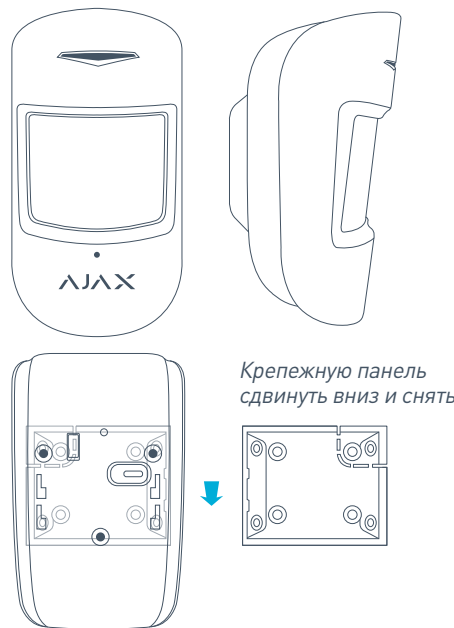
РИС. 1. Датчик CombiProtect и его крепежная панель
