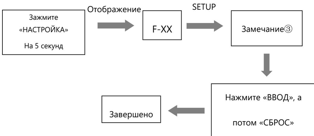
Замечание③: F (frequency - частота) означает рабочую частоту, нажмите кнопку «НАСТРОЙКА» чтобы выбрать частоту, диапазон частот находится в зоне от 1 до 12.
