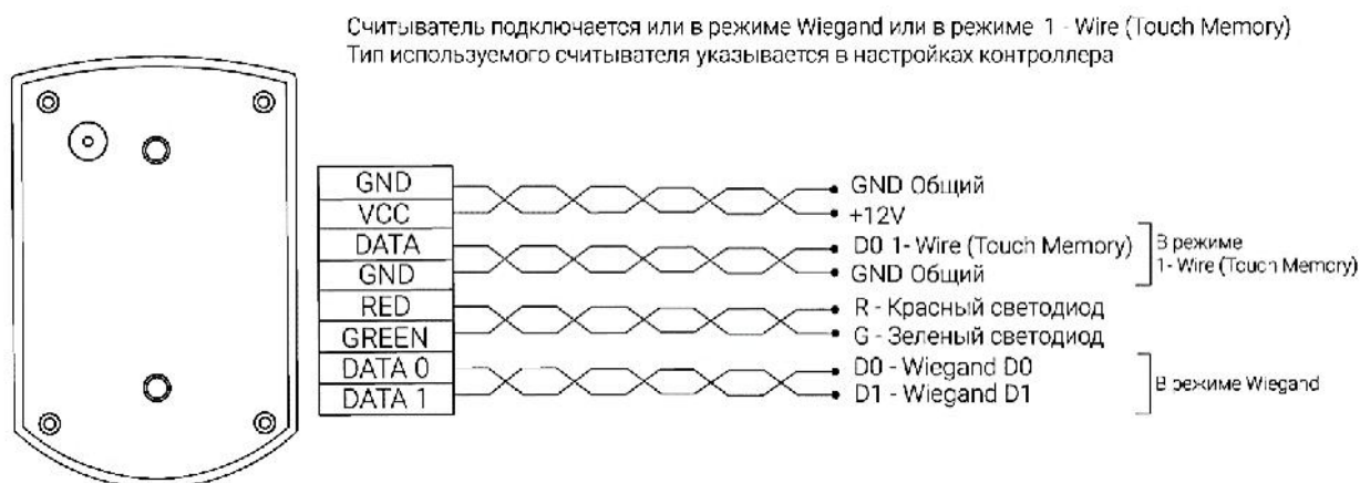
Рисунок 2 - Подключение считывателей Proximity карт или брелоков PR-XX
