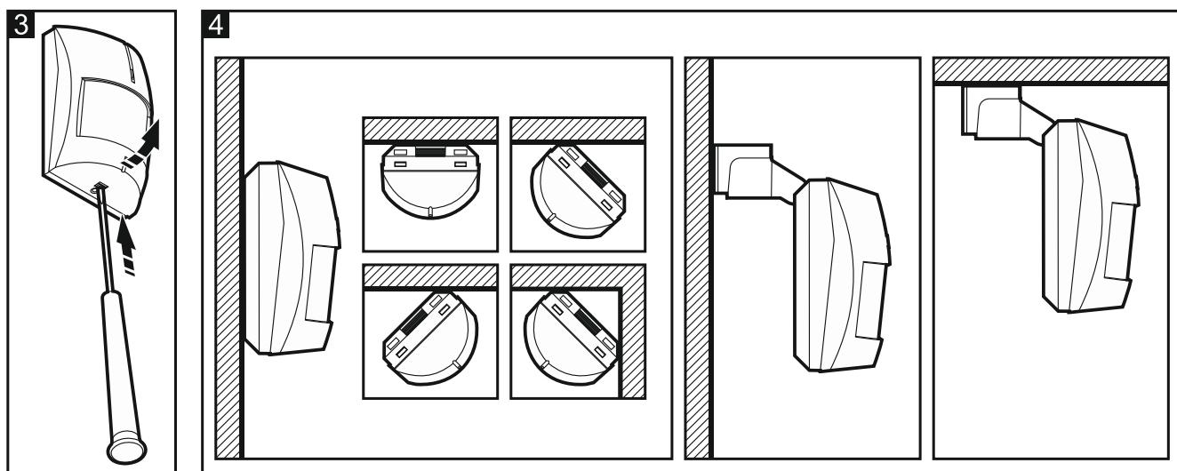
5. Прикрепите основание корпуса непосредственно к стене или к кронштейну, установленному на стене или потолке (рис. 4 и 5). Извещатель нельзя устанавливать на кронштейне, если должна быть включена опция игнорирования животных.
