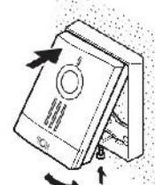
Вставте верхню частину викликної відео панелі у монтажну рамку та натисніть на нижню частину панелі. Закрутіть кріпильні гвинти у нижній панелі, щоб закріпити панель до рамки.
