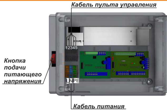
Рис. 14– Блок электронного управления – подключение турникета
