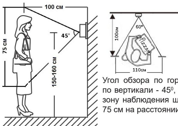
Угол обзора по горизонтали составляет  $60^\circ$ , по вертикали -  $45^\circ$ , что позволяет обеспечить зону наблюдения шириной 110 см и высотой 75 см на расстоянии 100 см от панели.
