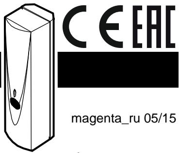
Извещатель MAGENTA позволяет обнаружить разбитие стекла: обыкновенного, закаленного и многослойного. Извещатель вызовет тревогу, если будет зарегистрирован по очереди звук низкой (удар) и высокой (разбитие стекла) частоты. Канал высокой частоты анализируется 4 секунды с момента обнаружения звуковой волны низкой частоты.
