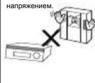
При установке прибора, во время работы которого вырабатывается тепло, желательно оставлять расстояние до стен сантиметров 5-10.
