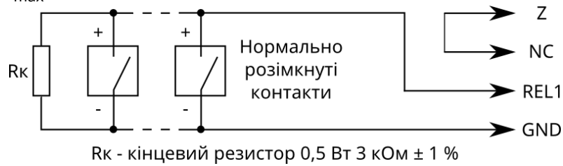
Рисунок 2.9 – Схема підключення двопровідних сповіщувачів з нормально розімкнутими контактами
