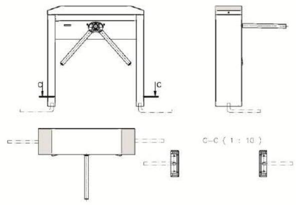
Рисунок 9 – Подвод кабелей турникета типа « трипод» в гофрированных или металлических трубах (условно)
