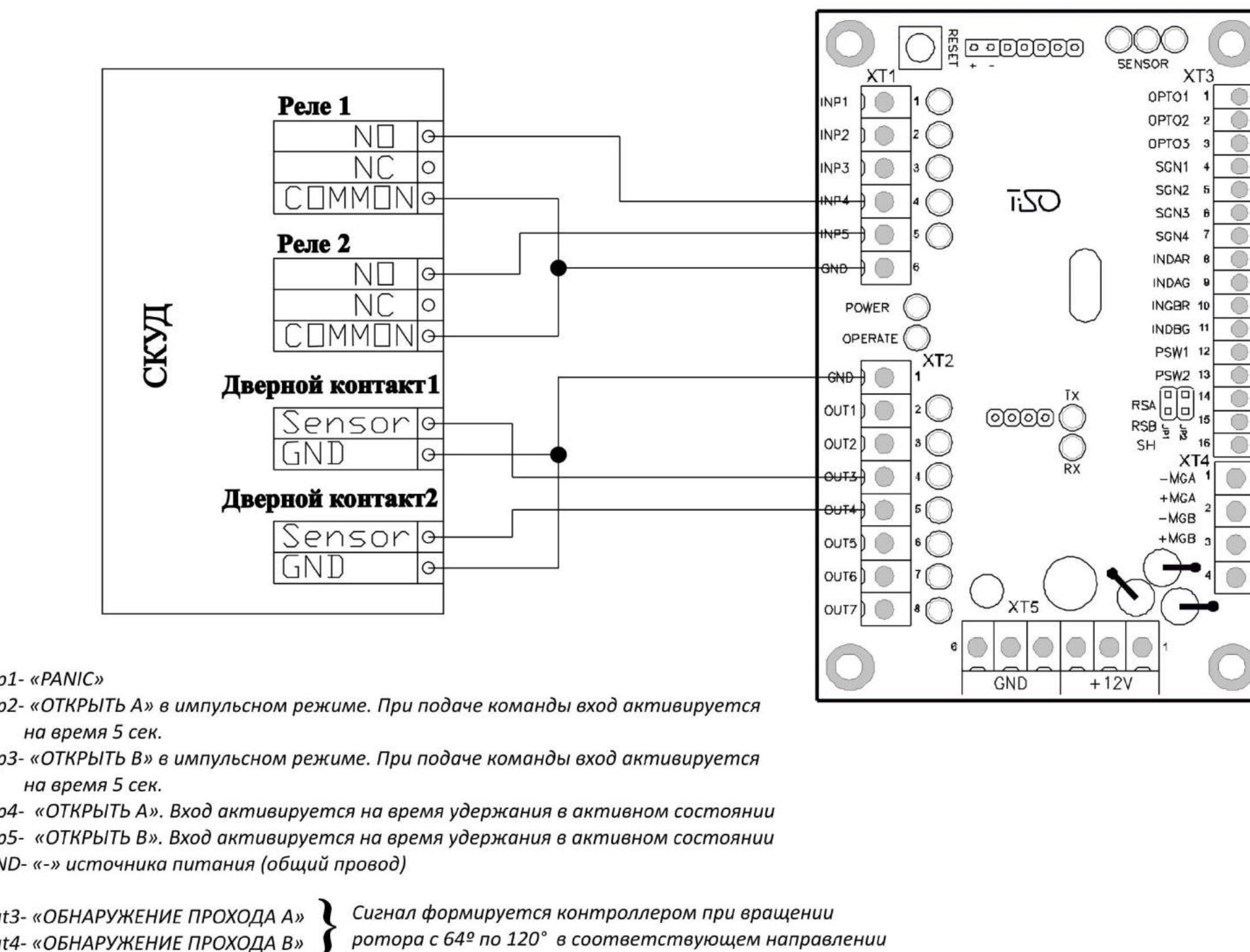
Рисунок Г.2 – Схема электрическая подключения турникета к СКУД
