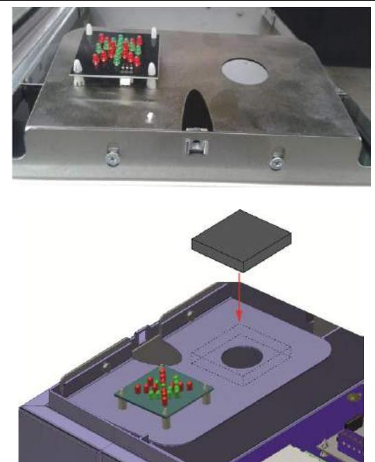
Рисунок 14– Место установка считывателя
