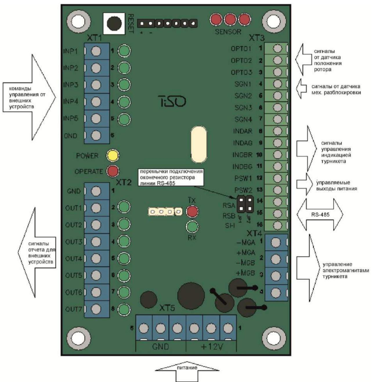
Рисунок 6 – Внешний вид контроллера турникета PCB.112.21.20.00
