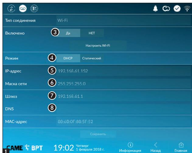
❸ Кнопка предназначена для включения/выключения соединения Wi-Fi.
