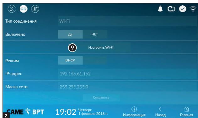
❹ После выбора режима соединения эта кнопка позволяет выбрать и настроить сеть Wi-Fi.
