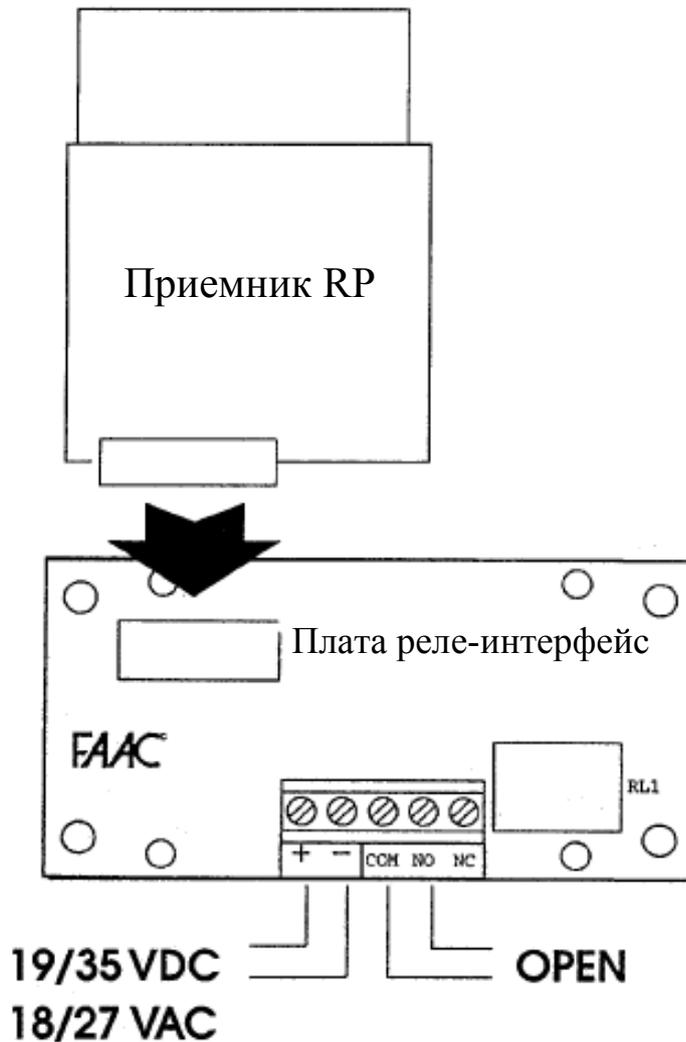
1. Приемник RP устанавливается на 5-ти штырьковый разъем. При этом обратить внимание на то, что плата приемника не должна выступать за пределы электронной платы реле интерфейс.
