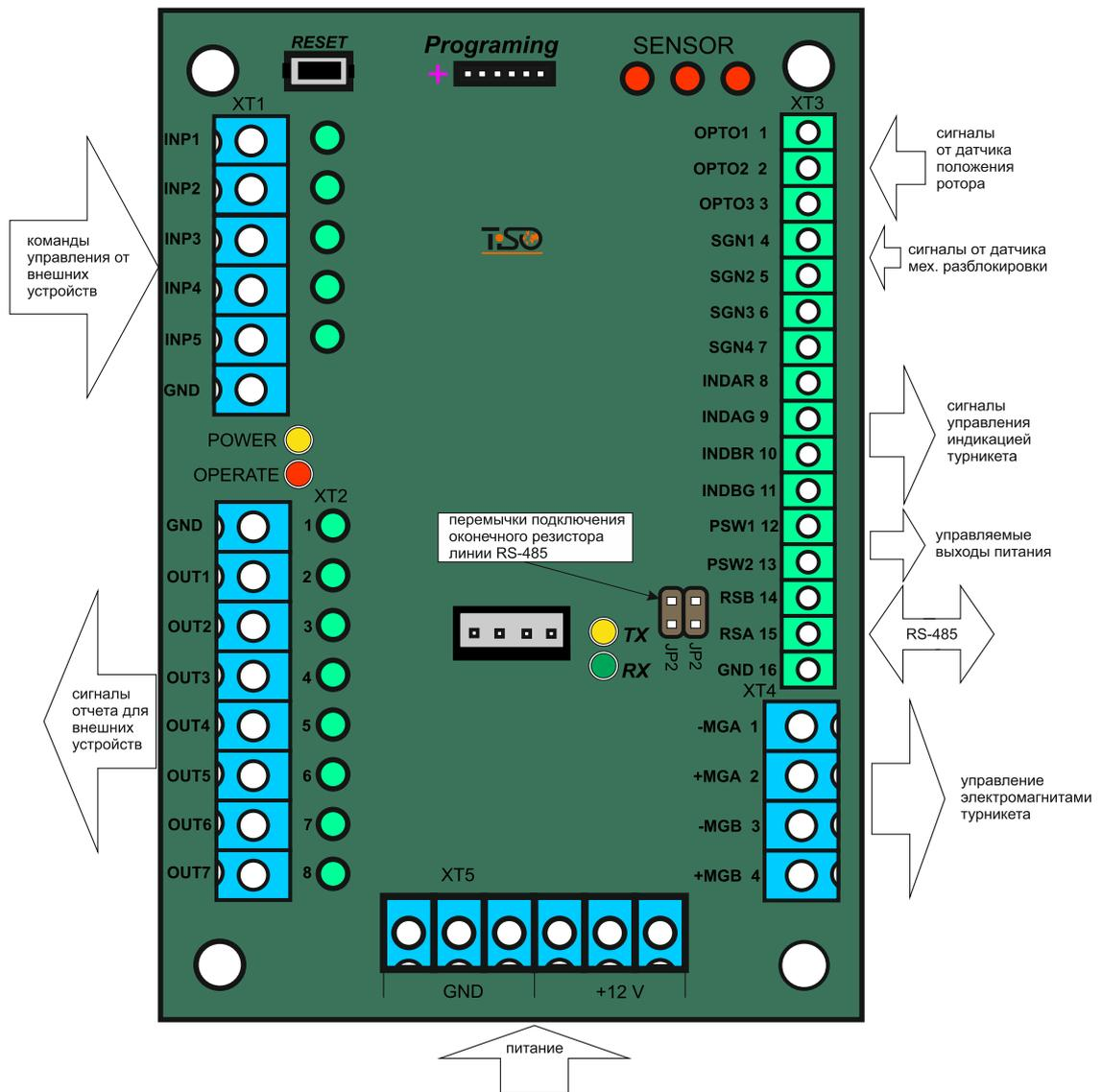
Рис. 8 – Внешний вид контроллера турникета РСВ.112.21.20.00
