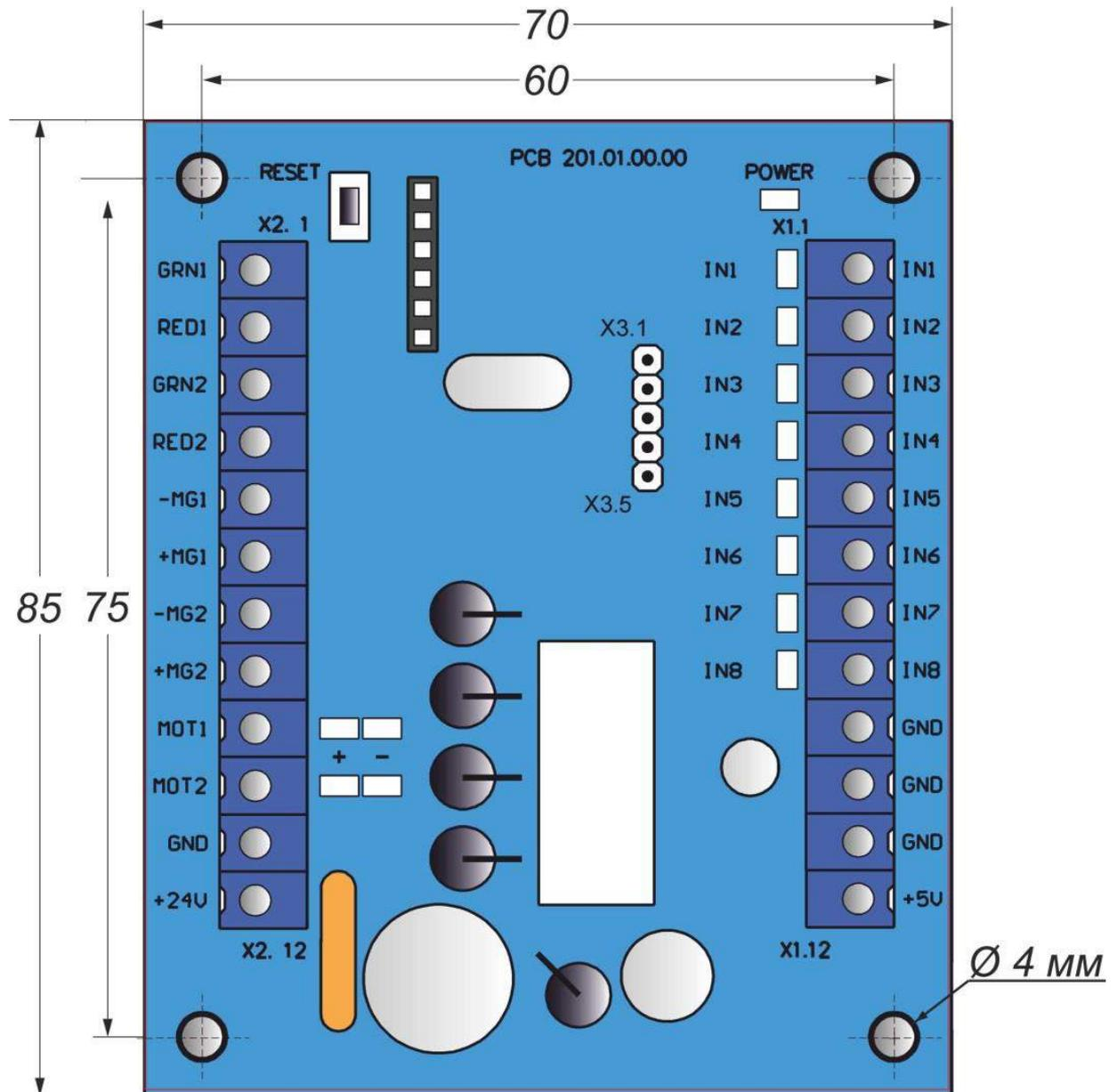
Рис. 7– Внешний вид контроллера моторизованного механизма РСВ.201.01.00.00
