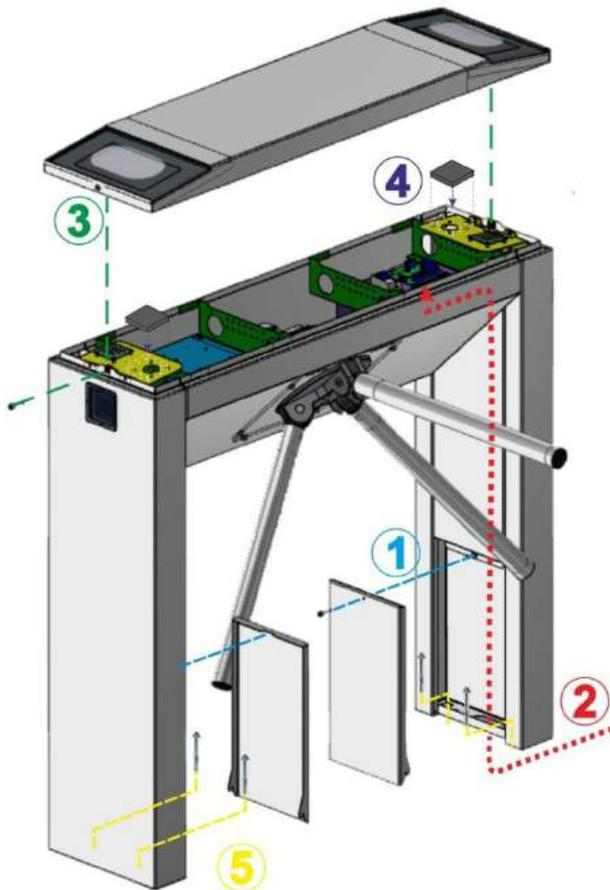
Рис. 13 – Общий вид сборки турникета трипода «TWIX-M»
