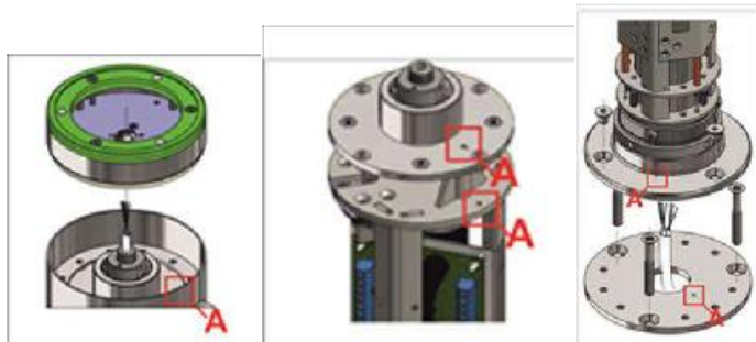
Рис.8 - Метки нулевого положения на сборочных деталях
