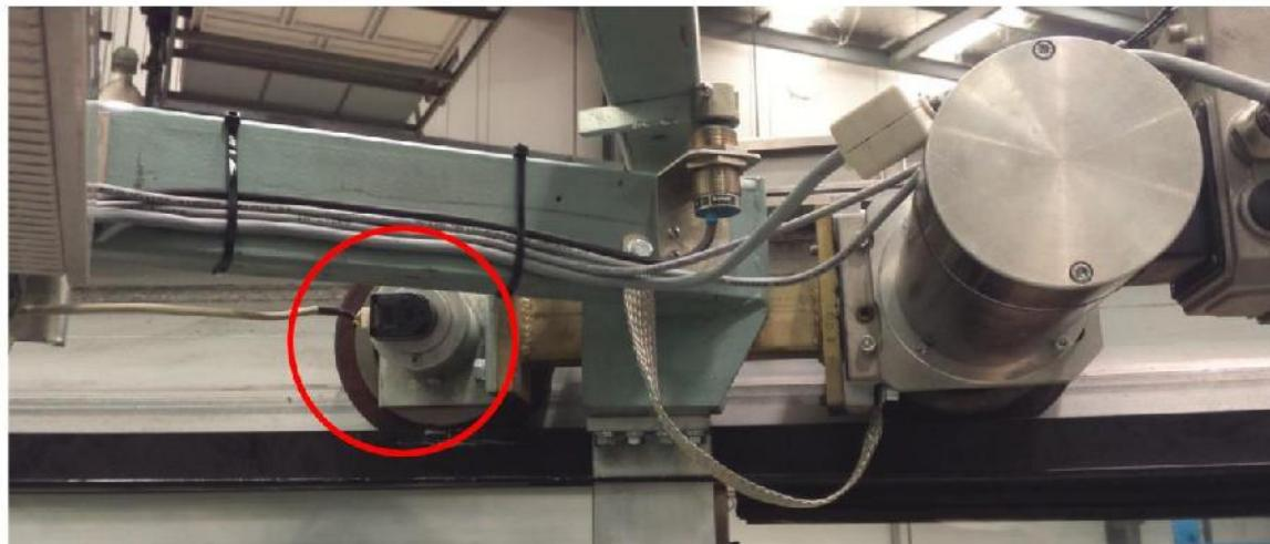
Инкрементный кодовый датчик (энкодер) расположен на блоке привода. Концевые соединители белого штекельного разъёма кабеля инкрементного кодового датчика (энкодера) № 5 должны быть направлены в сторону ротора. Обратная полярность выведет инкрементный энкодер из строя.
