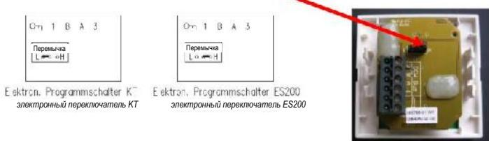
DIP-переключатели 1 + 2 модулей должны быть настроены следующим образом:
