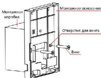
Рисунок 4-1 Установка монтажного основания
