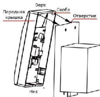
Рисунок 4-2 Установка передней крышки (1)
