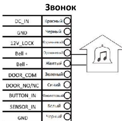
Рисунок 3-2 Схема подключения звонка
