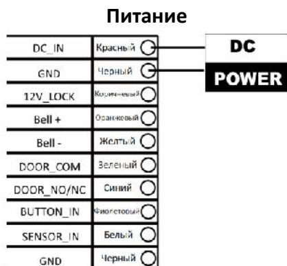
Рисунок 3-1 Схема подключения питания
