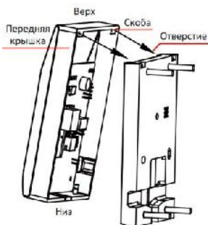
Рисунок 4-5 Установка передней крышки
