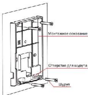
Рисунок 4-4 Установка монтажного основания
