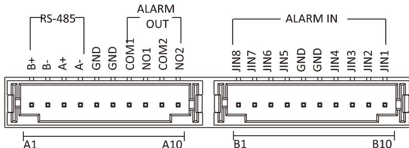
Рисунок 4-1 Разъемы DS-KH8301-WTS/DS-KH8301-WT/DS-KH8300-T
