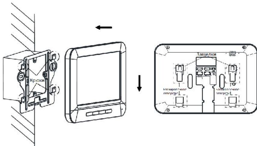
Рисунок 5-3 Крепление видеодомофона
