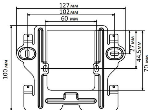
Рисунок 5-1 Монтажная пластина
