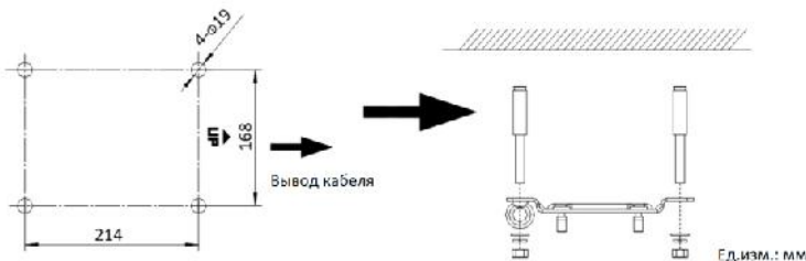
Рисунок 2-7 Установка монтажной пластины
