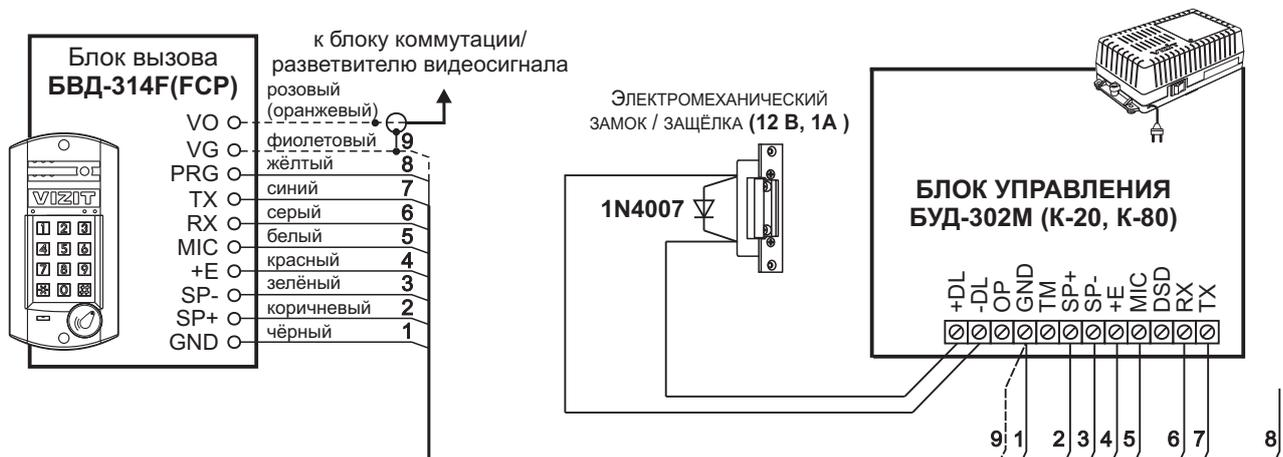
Рисунок 6 - Схема соединений блока вызова **БВД-314F(FCP)** с блоком управления **БУД-302М (К-20, К-80)** и электромеханическим замком / защёлкой
