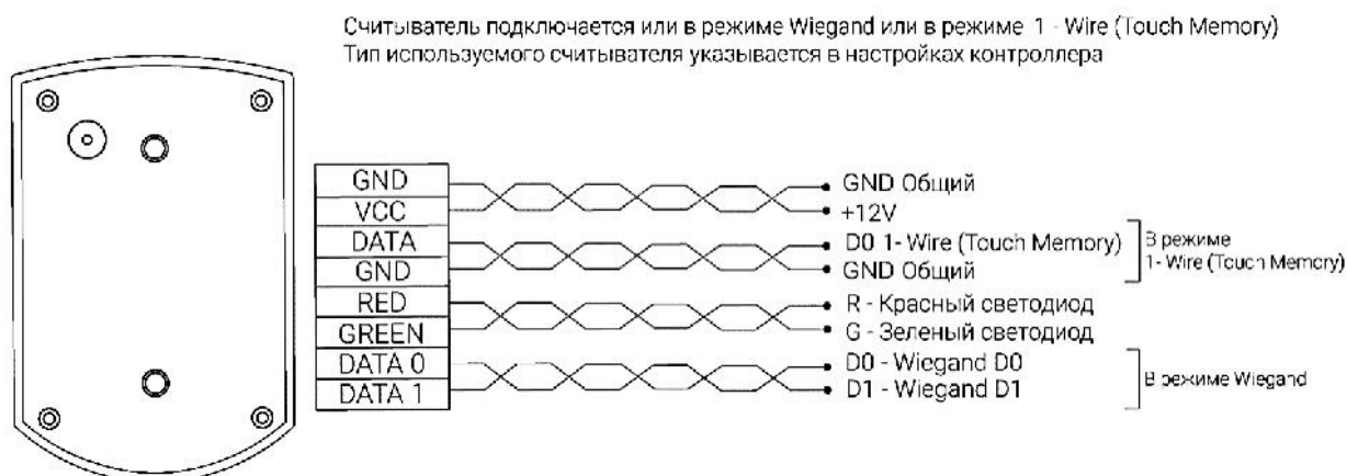
Рисунок 2 - Подключение считывателей Proximity карт или брелоков PR-XX
