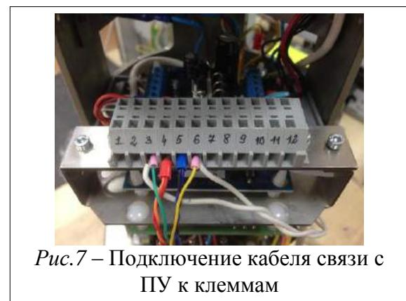
Рис.7 – Подключение кабеля связи с ПУ к клеммам
