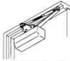
Паралельна тяга Монтуються з боку зачинення (стор.4)
