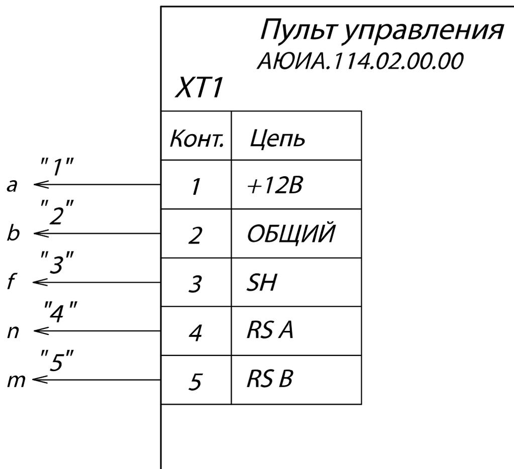
Рисунок Б.2 – Схема электрическая подключения пульта управления
