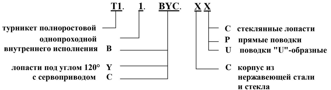
Пример записи обозначения турникета полноростового однопроходного, с сервоприводом, со стеклянными лопастями и корпусом из нержавеющей стали со стеклом при заказе:
