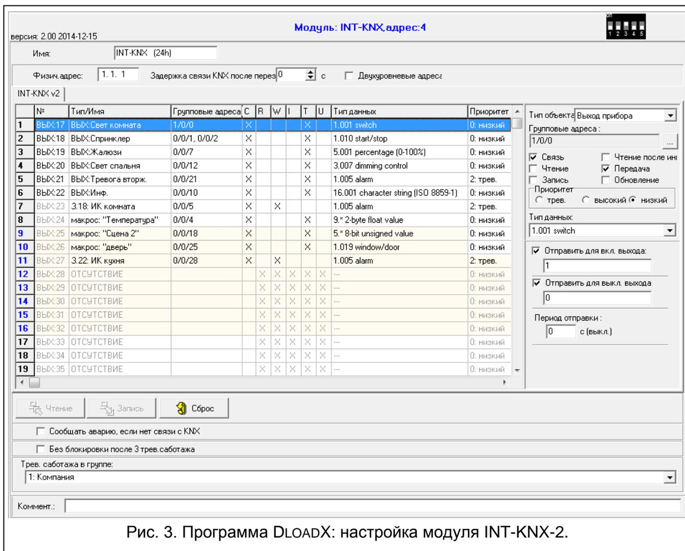
Рис. 3. Программа DLOADX: настройка модуля INT-KNX-2.
