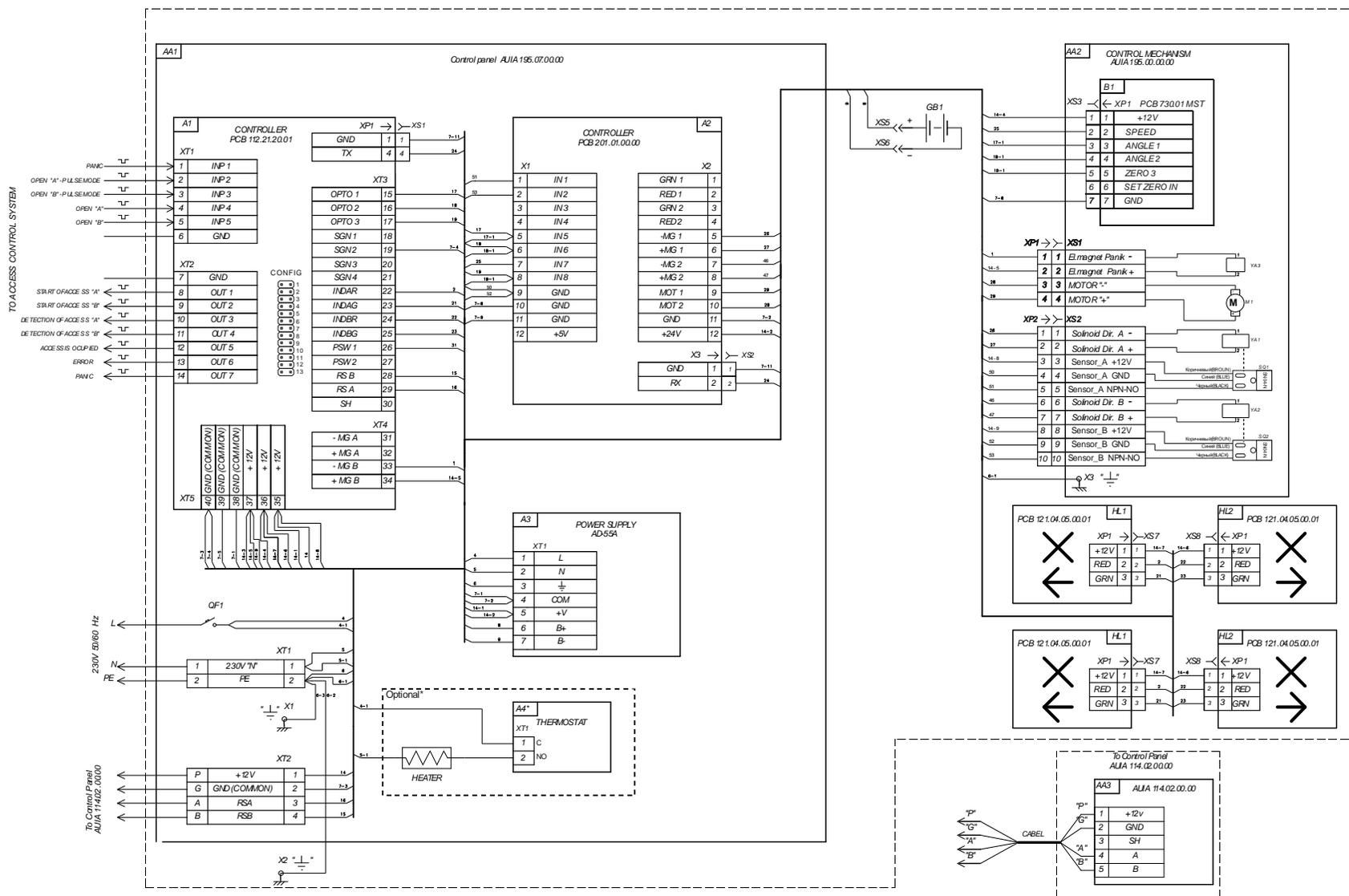
Приложение Г.1. Схема электрическая подключения турникета к системе контроля и управления доступом (СКУД)
