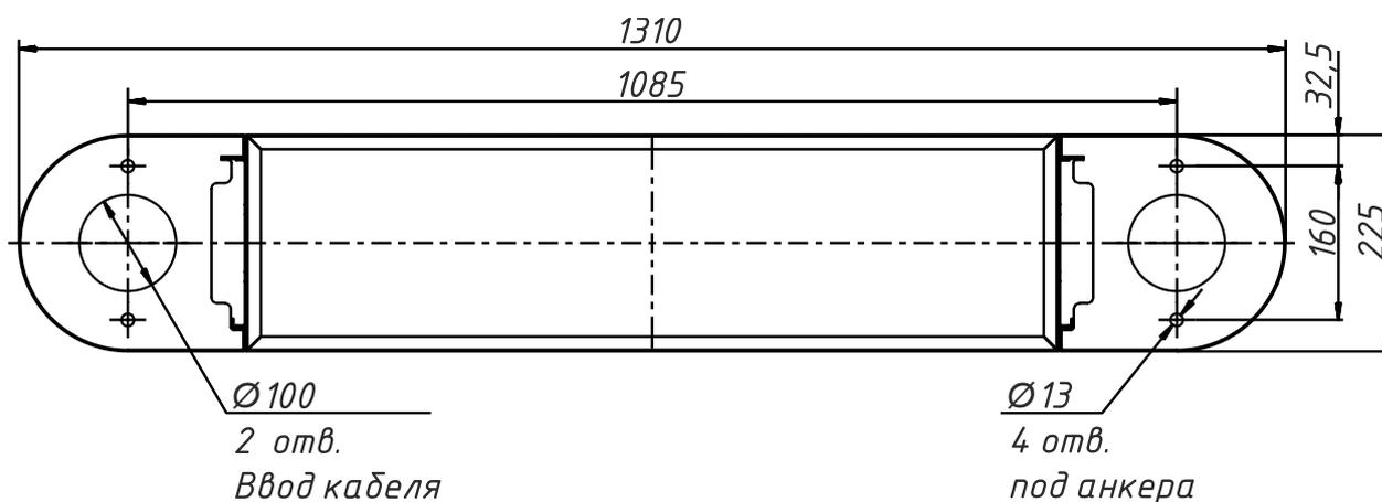
*Рис. 13–* Разметка для монтажа турникета типа «трипод»
