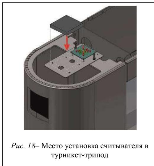
*Рис. 18– Место установка считывателя в турникет-трипод*
