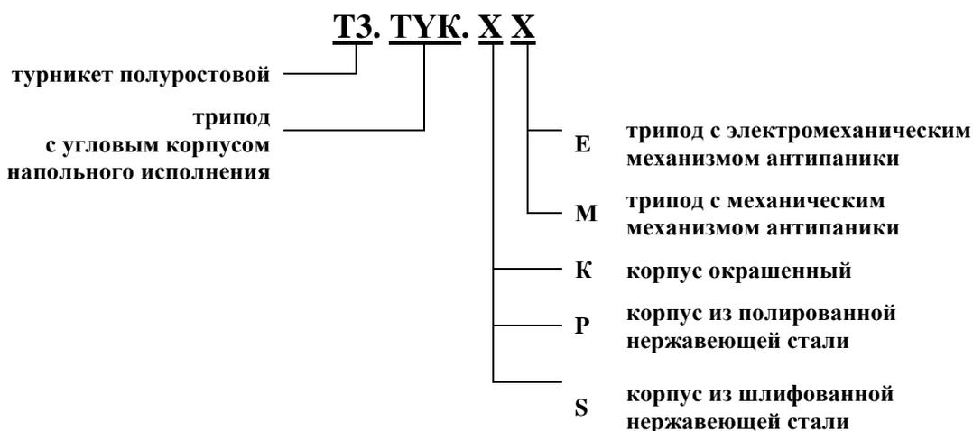
Пример записи обозначения турникета полуростового типа «трипод» с угловым корпусом из шлифованной нержавеющей стали с электромеханическим механизмом антипаники со стеклянной задней панелью при заказе:
