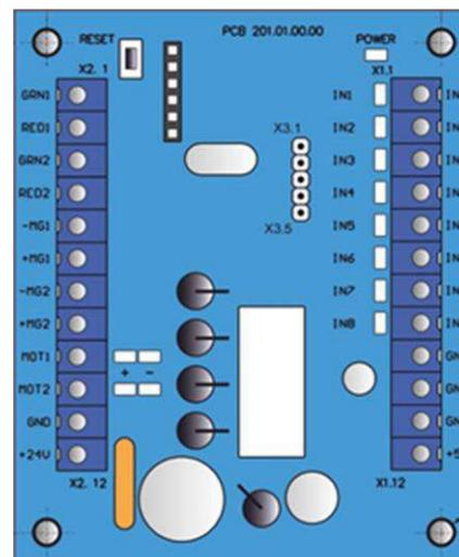
Рис. 9 – Внешний вид контроллера моторизированного механизма РСВ.201.01.00.00
