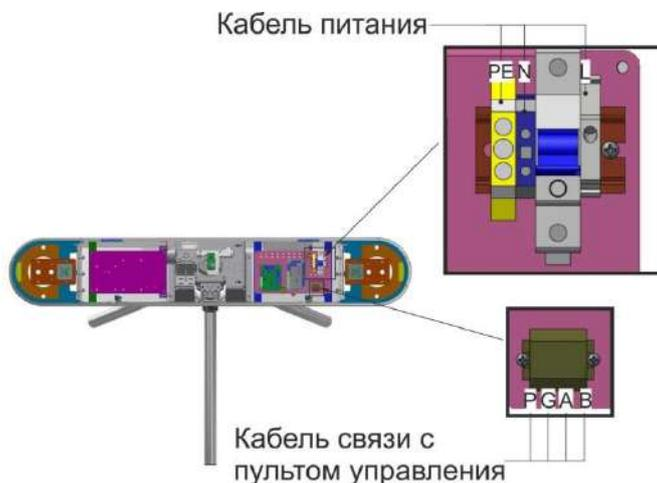
*Рис. 17– Подключение кабеля питания и кабеля связи с пультом управления триподе*
