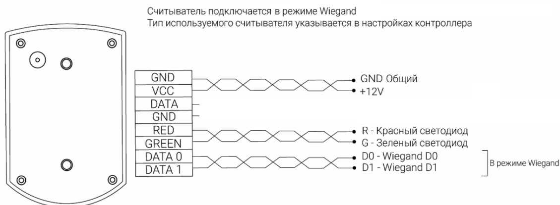
Рисунок 2 - Подключение считывателей Proximity карт или брелоков PR-XX
