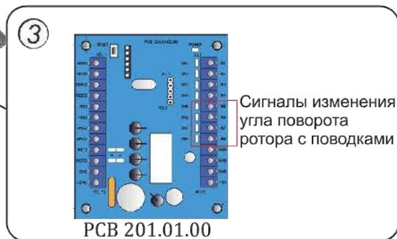
Рис.18 - Регулировка нулевого положения ступицы с поводками
