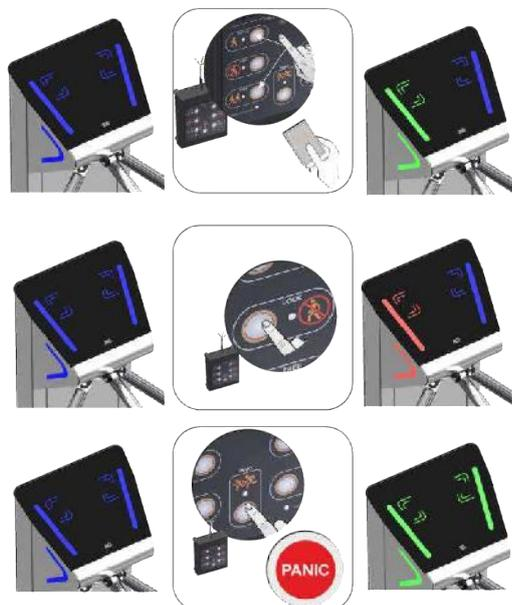
*Рис.5 – Статус светового табло индикации*
