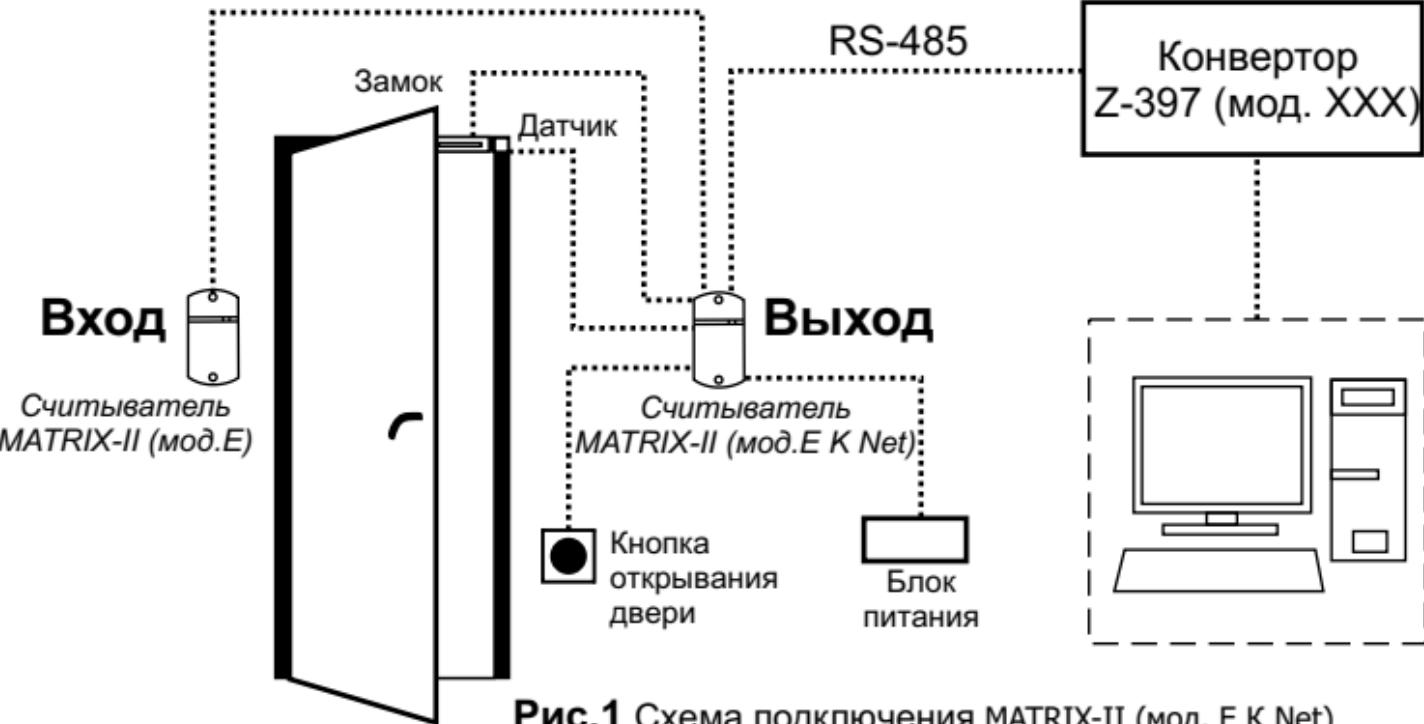
Рис.1 Схема подключения MATRIX-II (мод. E K Net)
