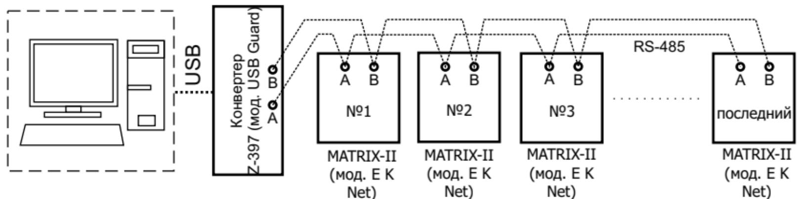
На рисунке приведён вариант подключения контроллеров к ПК. Термин "последний" означает, что считыватель MATRIX-II (мод. E K Net) является физически последним в линии связи.
