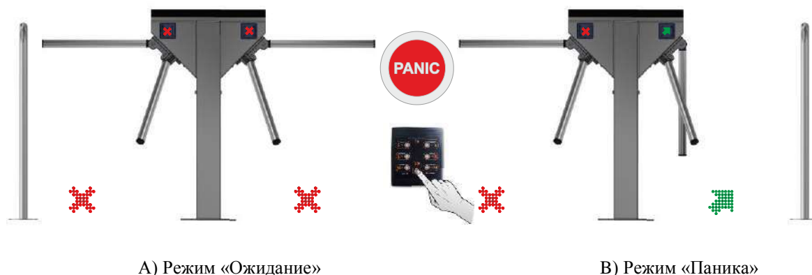
Рис.6 – Работа турникета в режиме «ПАНИКА»
