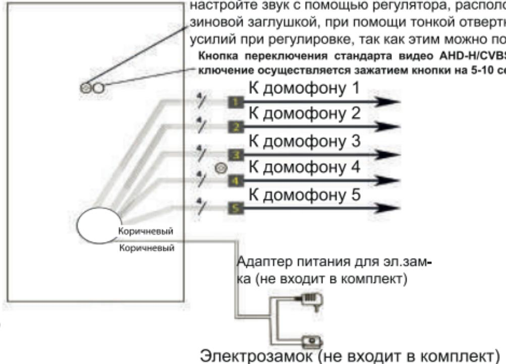
В случае недостаточного уровня звука на панели, его искажения или полного отсутствия настройте звук с помощью регулятора, расположенного на задней части панели под резиновой заглушкой, при помощи тонкой отвертки. Не следует применять значительных усилий при регулировке, так как этим можно повредить устройство.
