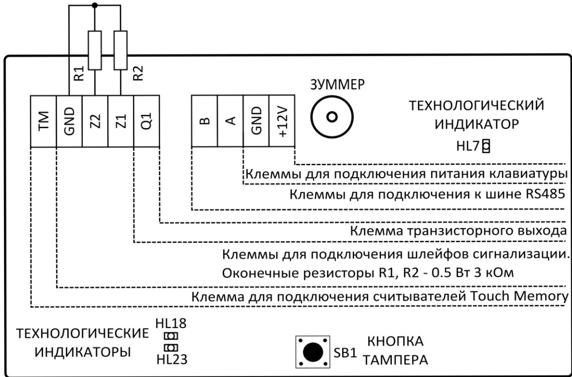
Рисунок 2 - Схема электрическая подключения
