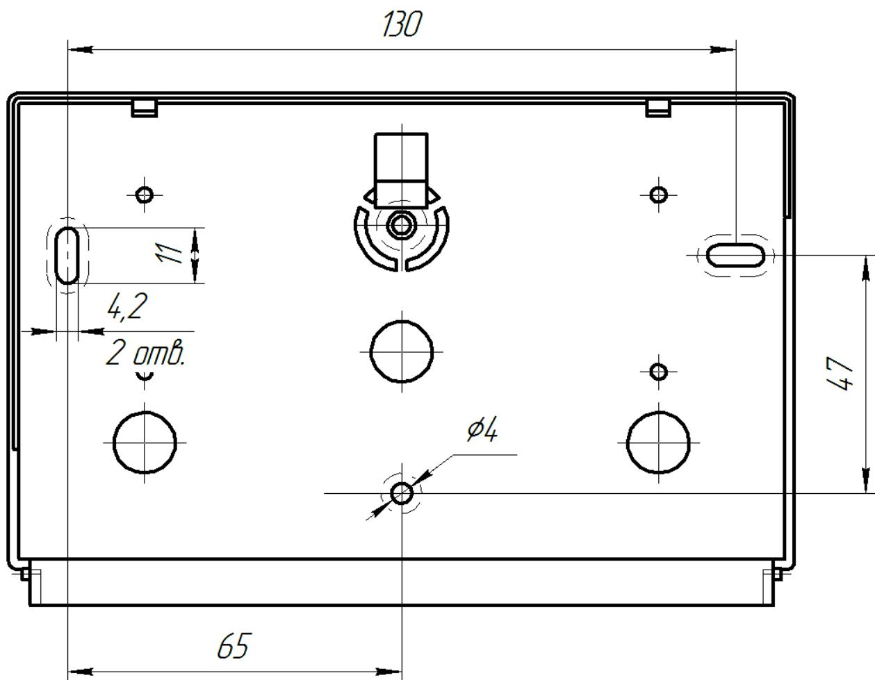
Рисунок 1 - Установочные размеры клавиатуры K-LCD
