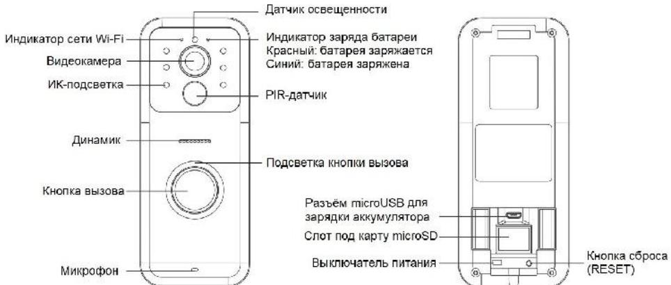
Индикатор сети Wi-Fi светится синим, если в данный момент времени установлено соединение мобильного домофона с сетью Wi-Fi. Диоды ИК-подсветки испускают излучение в невидимом человеческим глазом диапазоне, поэтому ИК-подсветка не видна визуально.
