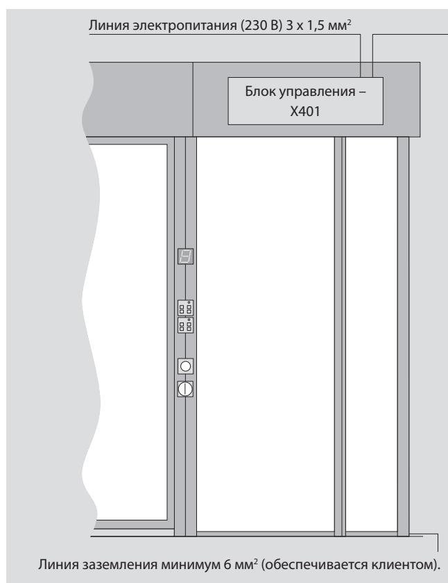
Для подключения внешних управляющих элементов используются следующие входы/выходы:
